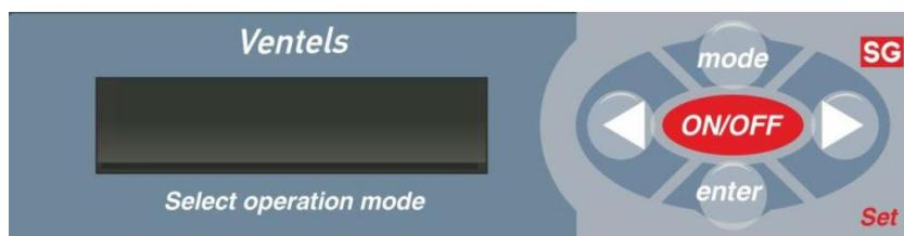
Кнопка “**ON/OFF**” пуск и остановка вентиляционной системы
